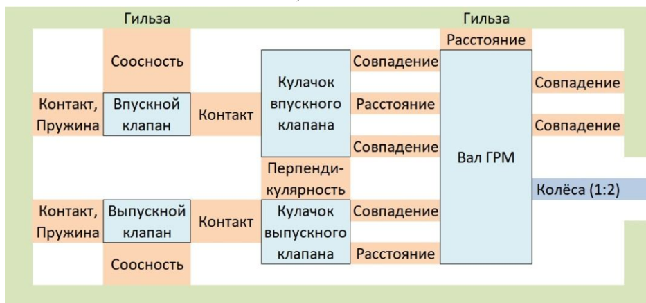
Рис. 3.7 – Кинематическая схема ГРМ
